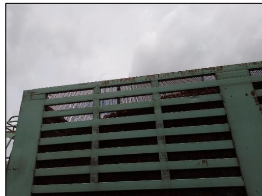
รูปที่ 2-29 การบุด้านในรถบรรทุก ด้วยตาข่ายไนลอนที่มีด้าย
